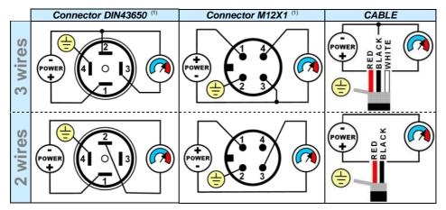
$^{(1)}\mbox{La}$  regolazione dello ZERO è accessibile svitando la ghiera. ZERO ADJUSTMENT is accessible by unscrewing the nut
